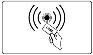
グラニュールに同梱されているRFIDカードはグラニュールのパラメーターと種類を識別するために使用します。 グラニュールの RFID カードで使用時間を延長することができるのは 1 台のみです。注意してください。カードは 使い捨てで 1 度しか使用できません。
